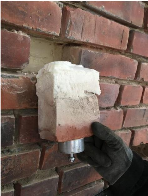
**Bild 4:** Haftzugsversuch, Quelle: Giffey Saxler Architekten
