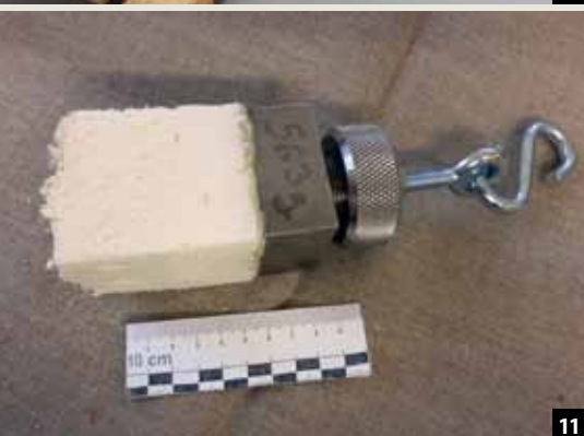
Abb. 10/11: Im Versuch hielt die Verbindung zwischen Ziegeln und PU-Schaum in allen Fällen stand. Abrisse entstanden wenn, dann nur im PU-Ortschaum.
